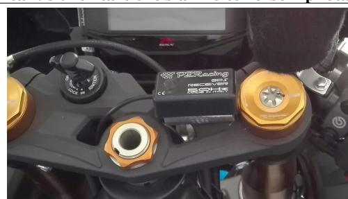
**Il serbatoio della moto ed i condotti dell'aria laterali sono altamente sconsigliati** in quanto il ricevitore GPS verrebbe completamente coperto dal busto e dalla testa del pilota ed inoltre durante una piega in curva il ricevitore GPS verrebbe completamente oscurato dalla moto stessa.
